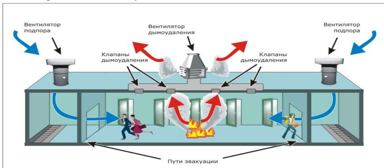
Рис. 14. Схема дымоудаления с искусственным побуждением
