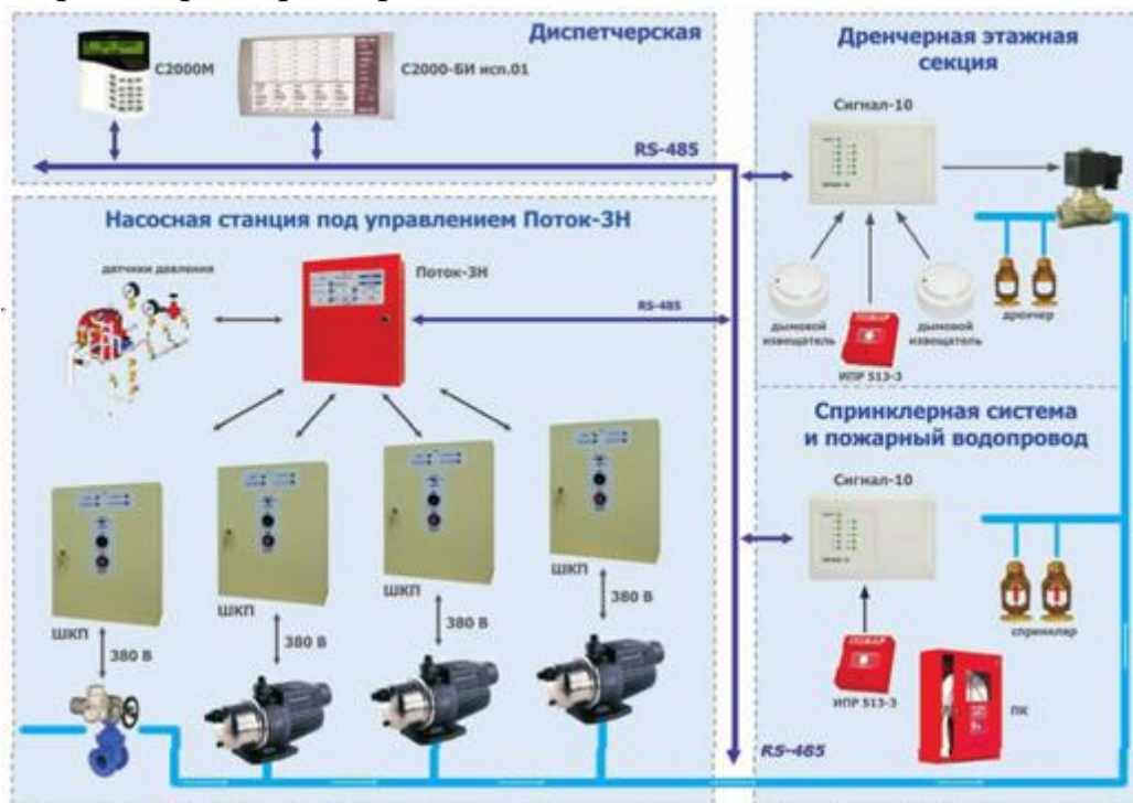
Рис. 7 Схема водяной АУПТ
